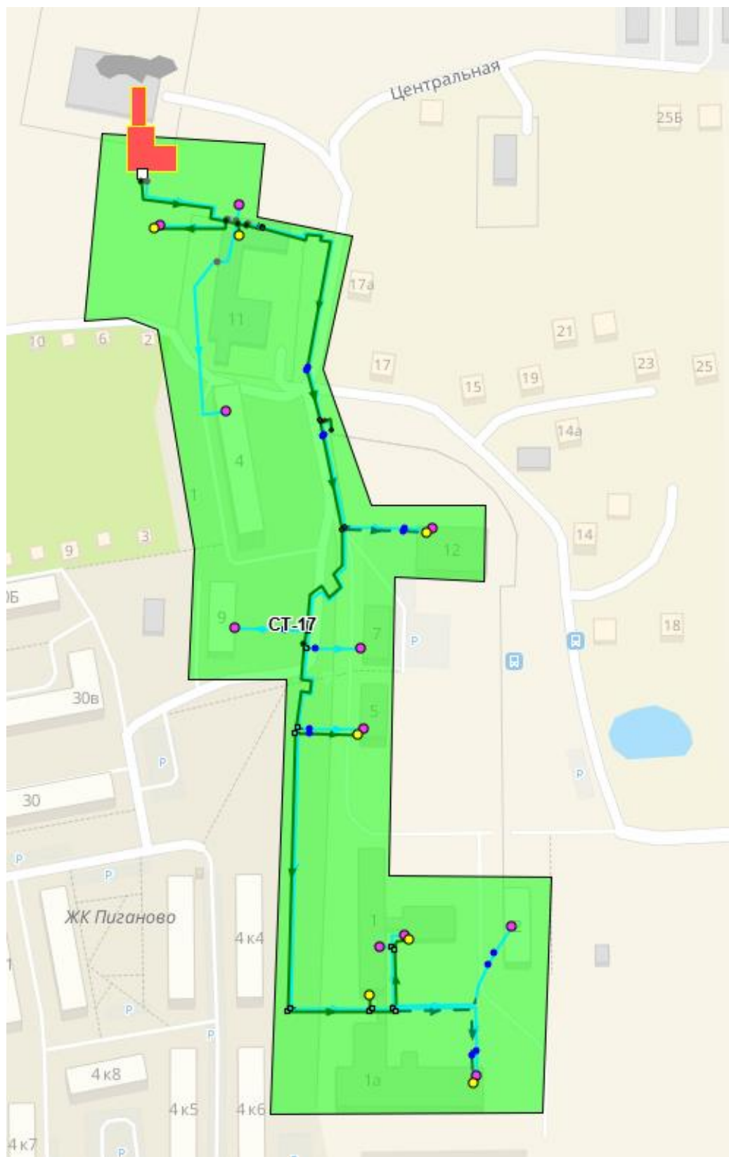
Рисунок 41 – Границы системы теплоснабжения котельная мкр. Пиганово
