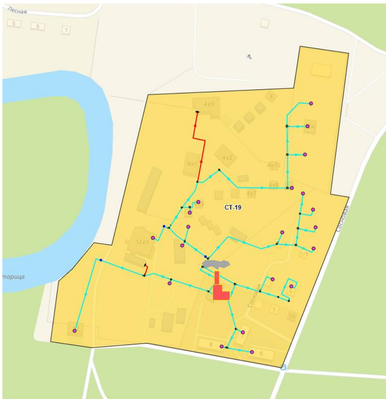
Рисунок 25 – Границы системы теплоснабжения котельная турбаза «Ладога»
